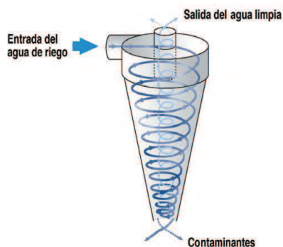
Figura 11. Esquema del funcionamiento de un hidrociclón. (Centro de Formación Agraria Viñalta, 2015).
