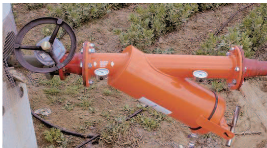
Figura 9. Filtro de malla. Obsérvese la colocación de manómetros a la entrada y salida del filtro para controlar la pérdida de presión. (Centro de Formación Agraria Viñalta, 2015).
