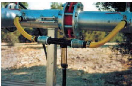
Figura 16. Dispositivo Venturi para inyectar la solución nutritiva al agua de riego. (Centro de Formación Agraria Viñalta, 2015).
