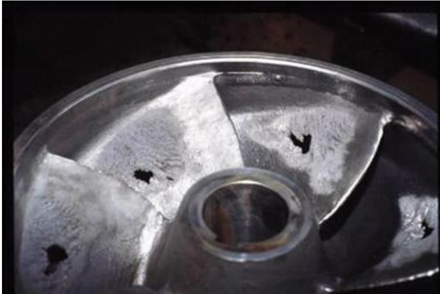
FIGURA 7. DAÑOS POR CAVITACIÓN DONDE LAS BURBUJAS COLAPSAN [16 Y 17].
