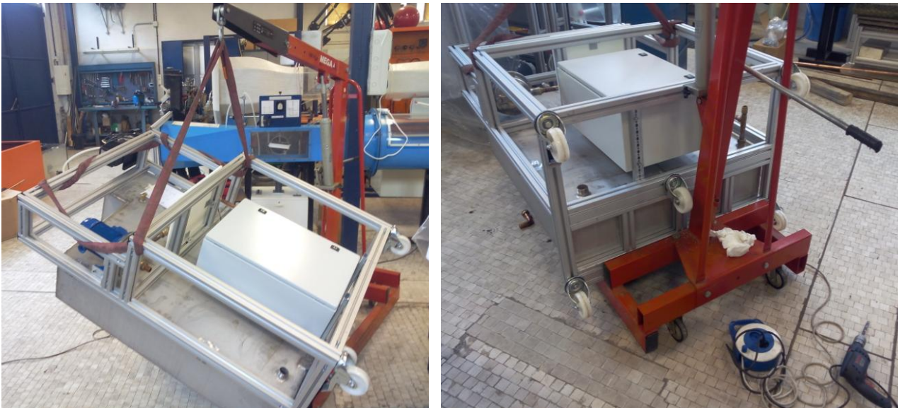
FIGURA 16. PROCESO DE COLOCACIÓN DE LA QUINTA RUEDA EN LA BASE DEL DEPÓSITO.
