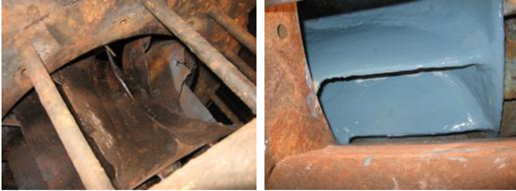
FIGURA 9. ANTES Y DESPUÉS DE UN ARREGLO DE UNA TURBINA CON BELZONA [24].
