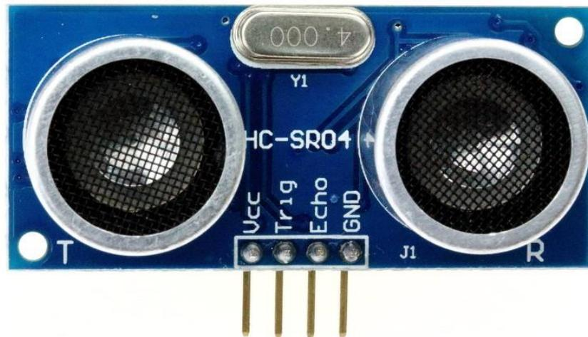
Le capteur qui a été utilisé dans notre projet est le capteur d'ultrasons HC – SR04.
