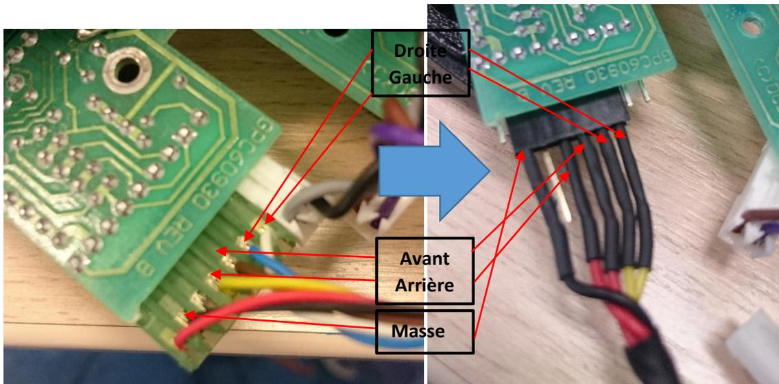
Pour obtenir les signaux qui faisaient fonctionner le fauteuil, nous avons vu qu'il y avait cinq fils qui envoyaient le signal pour déplacer le fauteuil. Un qui envoyait la courant à terre et quatre autres. Pour analyser l'interaction entre les quatre fils et les mouvements du fauteuil, nous avons remué le joystick et mesuré la tension qu'il y avait dans chaque fil. On présente un graphique avec les mouvements et les signaux correspondants :
