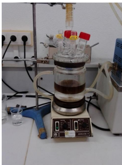
Figura 4.1. Reactor de tanque agitado utilizado para determinar el equilibrio de adsorción.
