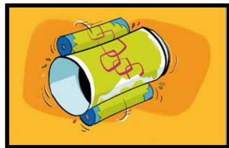
Acto seguido se le da forma al cuello de la lata en once pasos para no perforar el aluminio, aplicando al cilindro obtenido anteriormente la presión necesaria para moldear la lata se obtendrá un cuello en la lata de cinco centímetros.
