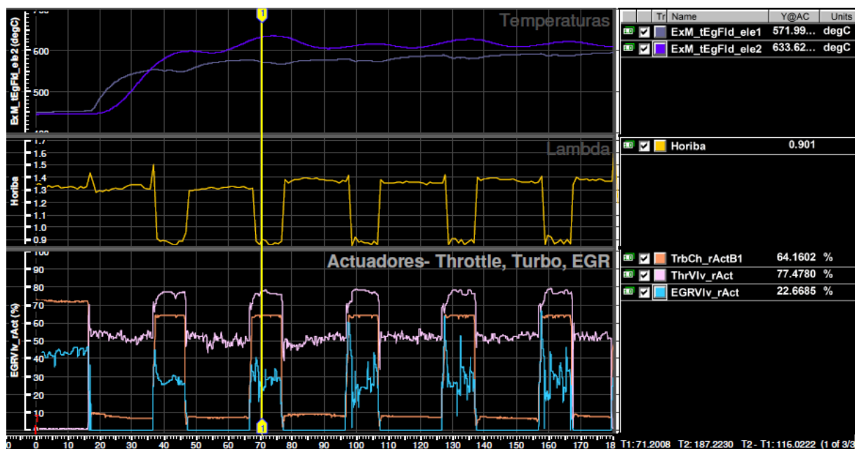
Figura 10. Grabación de un proceso DeSO x en banco de ensayos con software ATI Vision™
