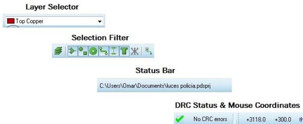
Figura 4.24 – Secciones de la barra de control
