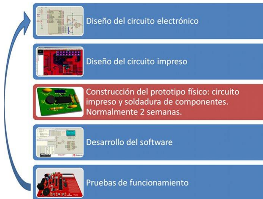
Figura 2.1 – Etapas para construcción de PCB sin Proteus
