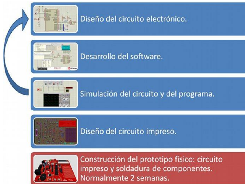
Figura 2.2 - Etapas para construcción de PCB con Proteus
