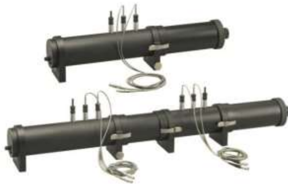
Figura 4.12. – Tubo de impedancias Bruel y Kjaer usado en este trabajo. Arriba: disposición para medir en absorción. Abajo: disposición para medir en transmisión
