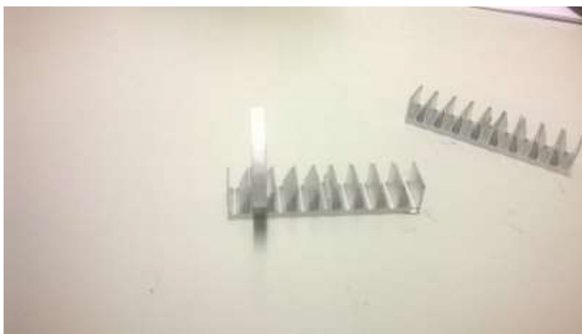
Figura 4.5. – Rejillas utilizadas para favorecer la absorción de gas, en ellas hay colocada una muestra a modo de ejemplo, dado que dicha muestra ya está espumada y cortada.
