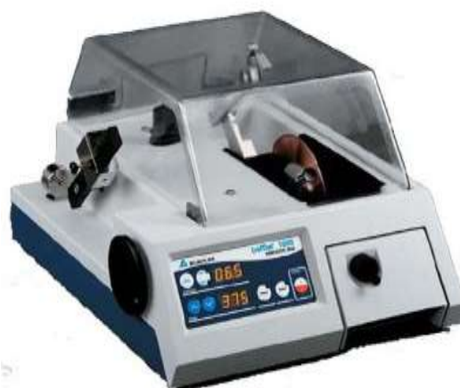
Figura 4.6. – Cortadora de precisión utilizada para que las muestras tengan las dimensiones adecuadas en los ensayos de acústica.
