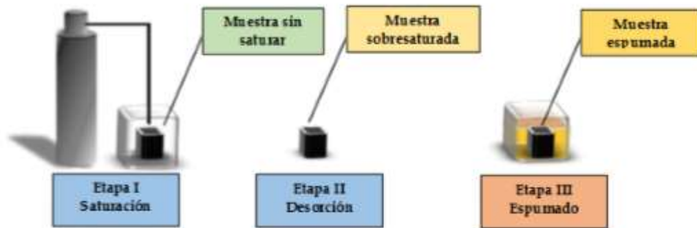
Figura 3.3 Esquema del proceso de disolución del gas.
