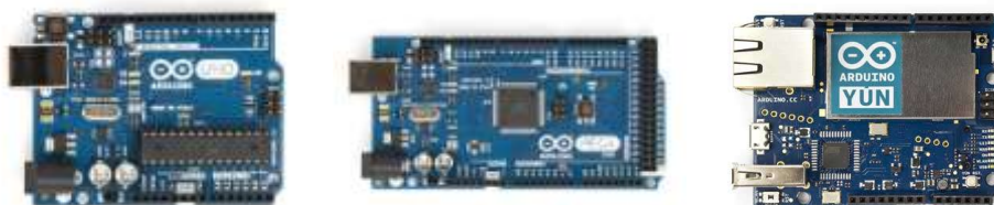
Ilustración 2: Placas de Arduino UNO, MEGA y YÚN
