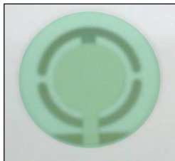
Figura 14. Cristal de cuarzo con electrodo de platino con 20 bicapas \text{FePcSO}_3^-/\text{PAH} depositadas mediante LbL.
