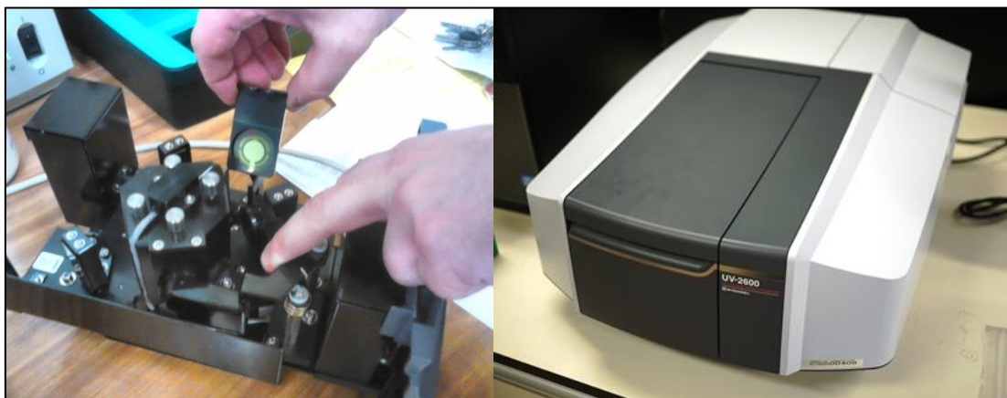
Figura 15. Espectrofotómetro UV-vis en el que se llevaron a cabo las medidas de absorbancia.
