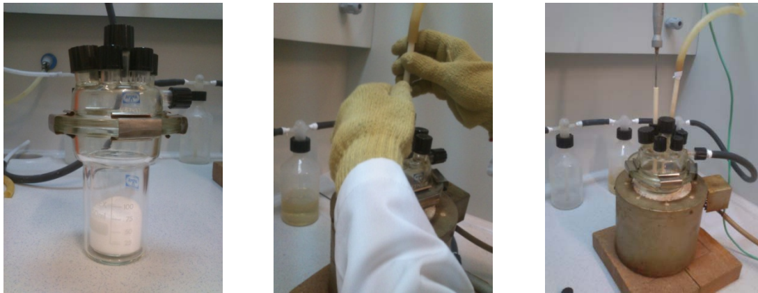
Figura 8.- Preparación de la celda dentro de la campana extractora.
