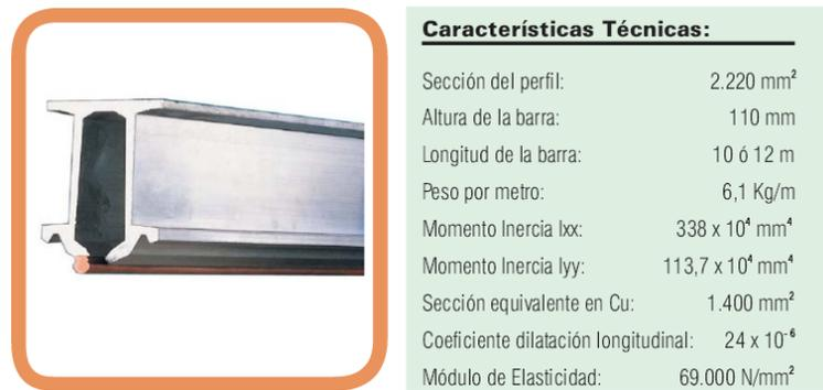
**Figura 1.** Catenaria rígida y características técnicas. De KLK Electro Materiales, (KLK, 2014)
