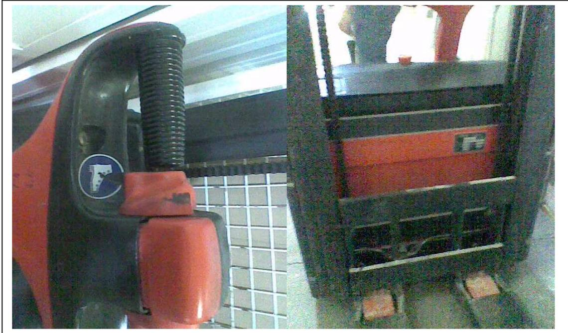
En éstas imágenes que adjunto se puede observar a la traspaleta de una forma general y específica, y podemos señalar que carece de resguardos en la cadena, pero que por otro lado tiene el marcado CE correspondiente y placas visuales que nos adviertes de la utilización de equipos de protección individual, lo cual es un valor añadido.
