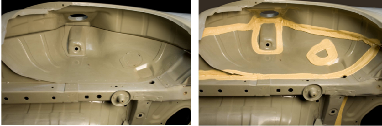
Figura 6: Aplicación de mástico de estanqueidad (revocoat.com)
