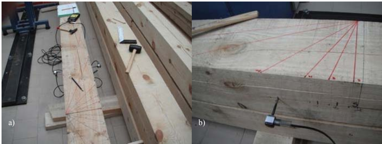
Figura 5. Reproducción de los abanicos de ángulos durante los ensayos.
