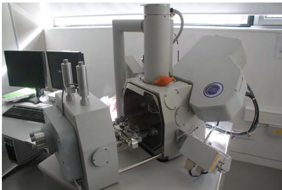
Figura 17: Microscopio Electrónico de Barrido Ambiental (ESEM) . Este es el ESEM localizado en el Centro Nacional de Investigación sobre la Evolución Humana (CENIEH) y que se ha utilizado para obtener imágenes de la superficie del esmalte de todos los dientes sobre los que se cuantificaron los perikymata. Fotografía: Mario Modesto Mata.
