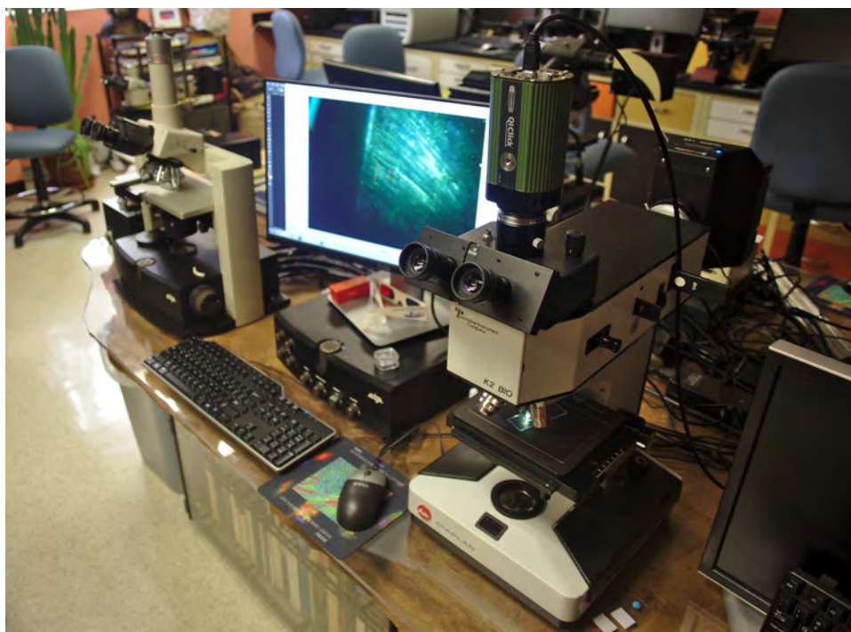
Figura 21: Microscopio optico de barrido confocal portátil (PCSOM) . Este PCSOM está fotografiado en el College of Dentistry de la Universidad de Nueva York. Uno similar fue prestado al Centro Nacional de Investigación sobre la Evolución Humana (CENIEH) para realizar los estudios de la periodicidad de los dientes fósiles fracturados de modo natural. Fotografía: Mario Modesto Mata.
