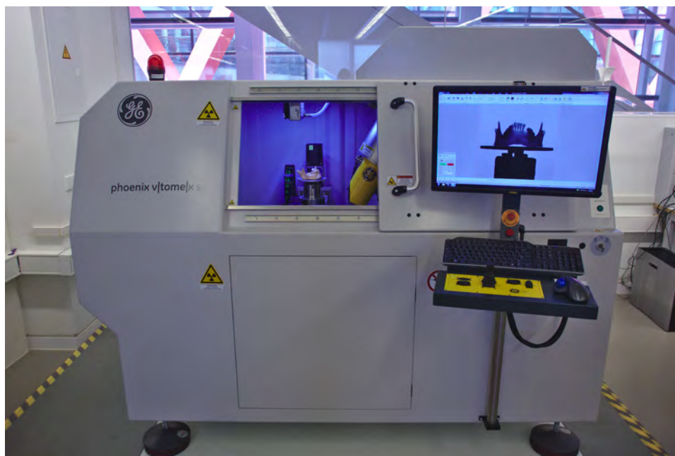
Figura 40: MicroCT Phoenix v|tome|x s de GE Measurement system. Este microCT se localiza en el Centro Nacional de Investigación sobre la Evolución Humana (CENIEH) y es uno de los empleados para escanear los dientes tanto de Sima de los Huesos, como de Gran Dolina-TD6 y de humanos modernos. Fotografía: Mario Modesto Mata.
