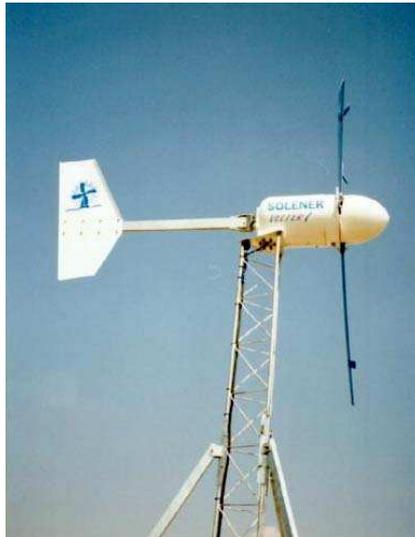
*Fig.3.17. Aerogenerador con torre en celosía.*
