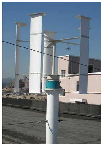
*Fig.3.10. Aerogenerador con rotor Giromill.*
