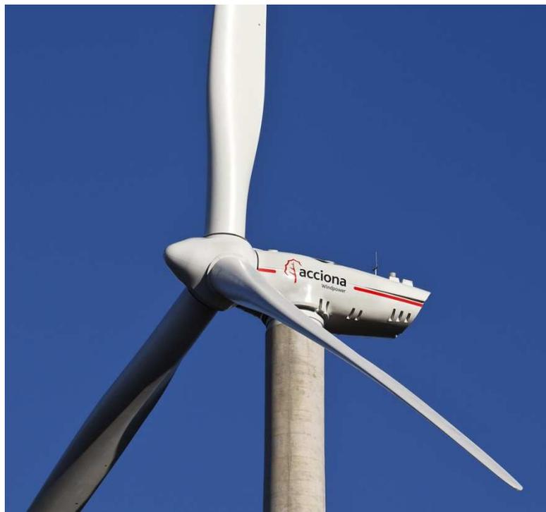
*Fig.3.19. Aerogenerador con torre tubular de hormigón.*
