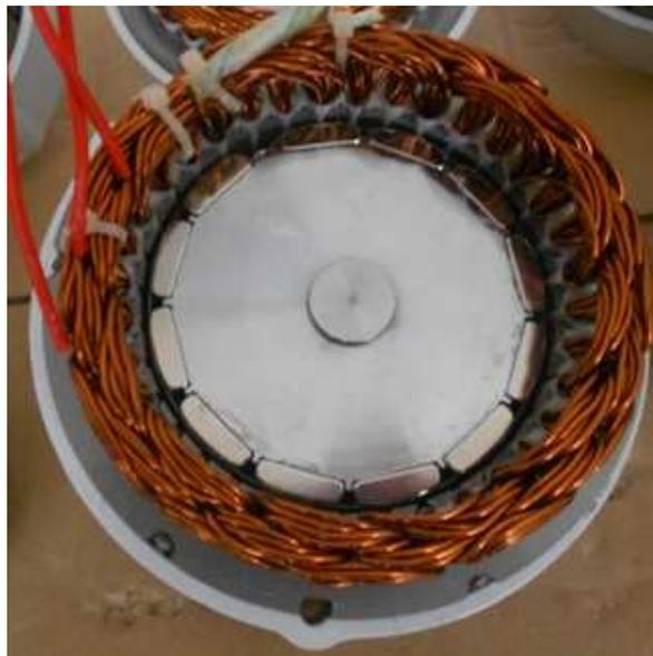
*Fig.3.26. Generador síncrono de imanes permanentes.*
