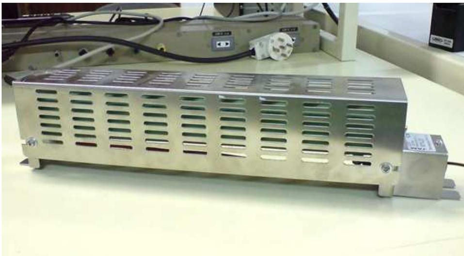
*Fig.5.17. Resistencia de break.*
