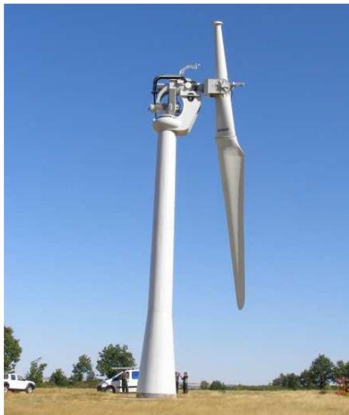
*Fig.3.14. Aerogenerador con rotor Monopala.*
