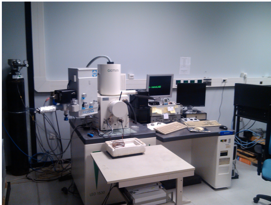
Fig.3 Microscopio electrónico de barrido (MEB) LEO 1530 con el sistema Gatan Mono CL2 acoplado.
