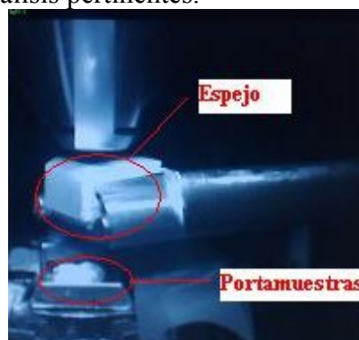
Fig.4 Interior de la cámara de vacío del microscopio, con el espejo recolector
