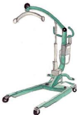
Figura 14: Elevador mecánico móvil. Gobierno de Aragón. La tarea de cuidar: Higiene postural, movilización y transferencias. 2011. Manual de buenas prácticas para el cuidador. P. 51.
