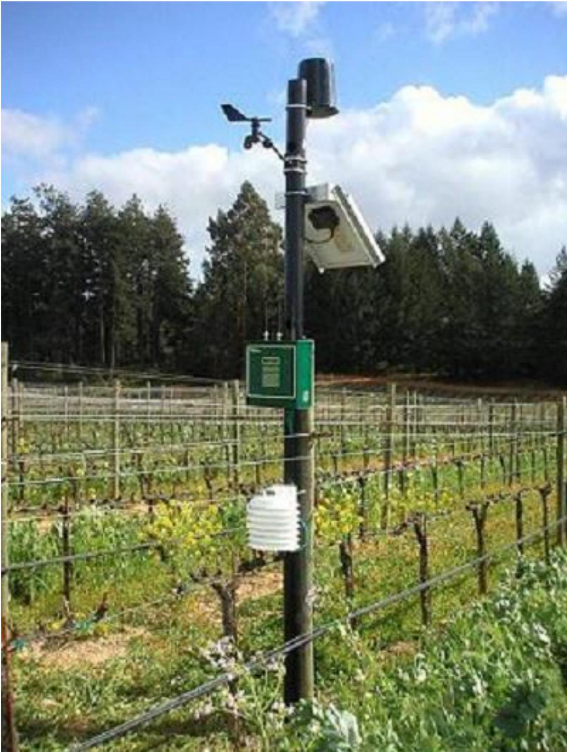
Figura 28 – Sensores ambientales para medir parámetros fenológicos del fabricante Ranch System.
