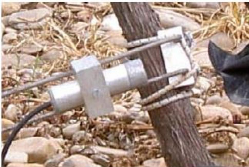
Figura 26 – Dendrómetro del fabricante Plantsens.
