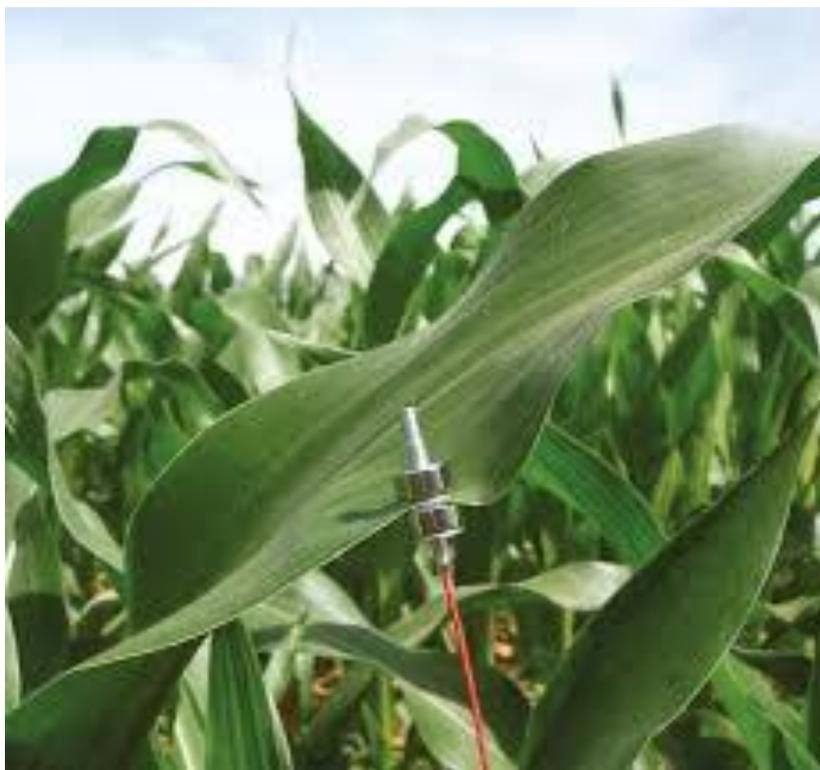
**Figura 27 – Sensor de temperatura y turgencia de hoja del fabricante Yara Zimplant.**
