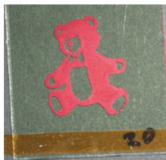
Dispositivo ITO/polycarbonato:TPD/Alq/Mg:Ag fabricado por screen printing
