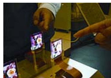
Dos ejemplos de transparencia en configuraciones de matriz pasiva y activa. La fotografía de la derecha (correspondiente a un AMOLED) ha sido tomada de Samsung SDI.
