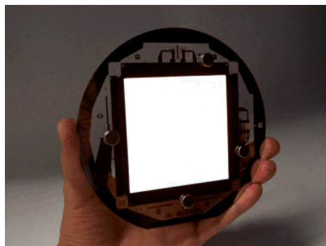
Último resultado del proyecto OLLA (junio 2008): WOLED de 10x10 cm 2 sobre una capa HC Starck Clevios TM PH510 PEDOT, con eficiencia de 50.7 lm/W y vida media superior a 10000 horas para 1000 cd/m 2
