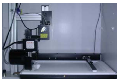
Balanza de Langmuir modelo 661, para la deposición de películas ultrafinas, del fabricante Nima.
