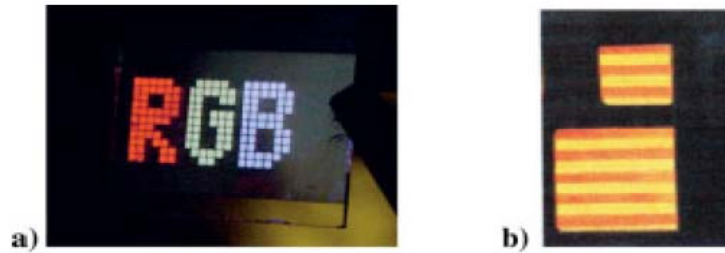
Fotografías de dispositivos multicolor procesados en solución: (a) Dispositivo RGB obtenido por litografía común. (b) Dispositivo bicolor obtenido por litografía de chorro electrónico.
