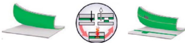
Proceso de impresión LITI (adaptado de Blanchet et al. [418]).
