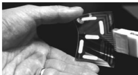
Display flexible de siete segmentos fabricado con polímeros semiconductores y metálicos
