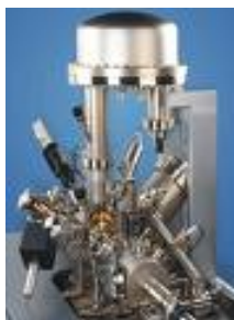
Equipo multitécnica ESCALAB 250 iXL , que incorpora las técnicas XPS, AES (ver epígrafe siguiente) e ISS (espectroscopia de dispersión de iones).
