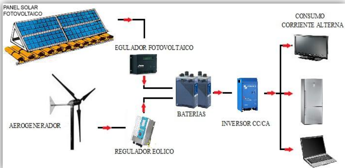
Fig.1: Componentes de una instalación mixta
