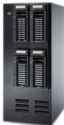
Ilustración 7: Sistema Magstar de cintas Mod.3590, usado en los repositorios de RNE en Madrid.
