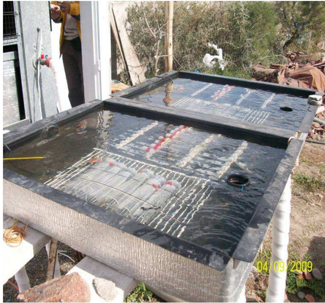
Figura 2.5. Incubaciones en condiciones simuladas in situ , realizadas en baños térmicos bajo radiación natural y a dos condiciones simuladas de temperatura. Los tratamientos de radiación aplicados fueron PAB (PAR+RUV; 280-700 nm), PA (PAR+RUV-A; 315-700 nm) y P (PAR: 400-700 nm), o PAB y P (ver más adelante en el texto).
