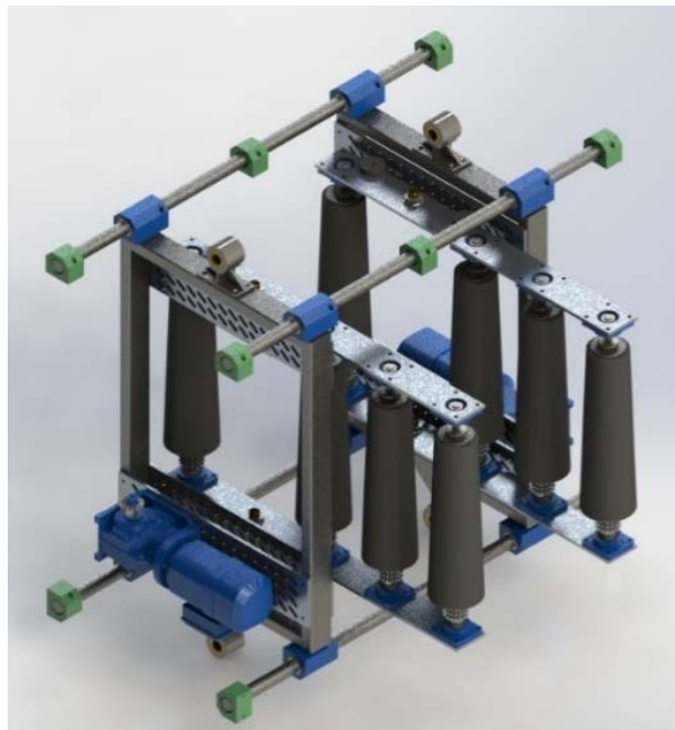
Figura 97 – Mecanismo de arraste, representado em vista isométrica explodida e assemblada
