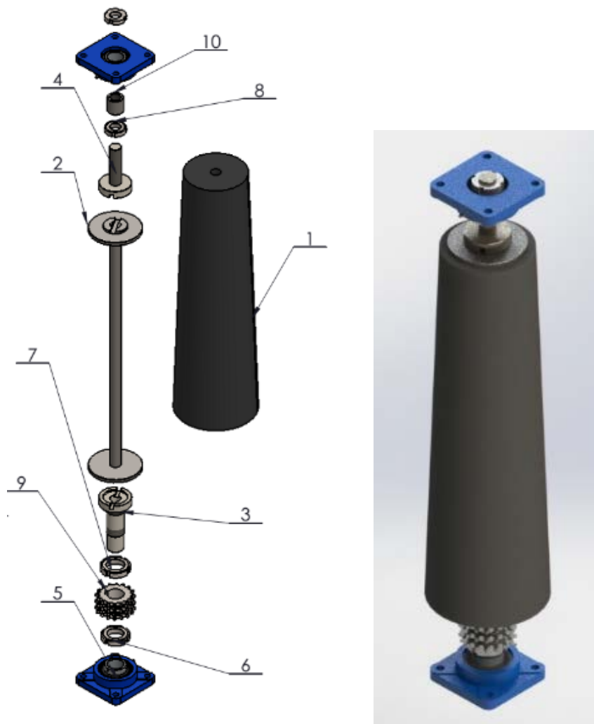
Figura 98 – Rolo do mecanismo de arraste, representado em vista isométrica explodida e assembled
