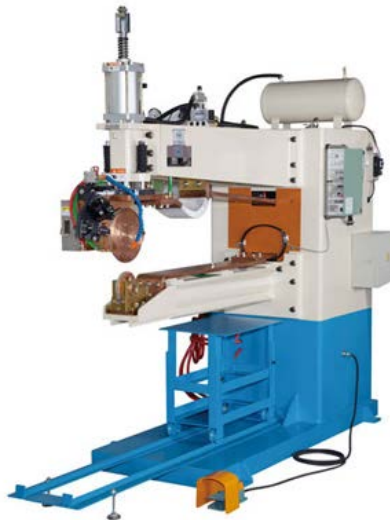
Figura 8 – Máquina de soldadura contínua por resistência [64]
