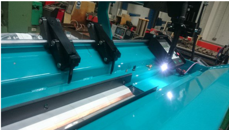
Figura 10 – Máquina automática de soldadura longitudinal por fusão [64]
