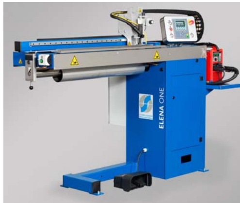
Figura 11 - Máquina de soldar longitudinalmente condutas da marca “ELENA ONE” [65]
