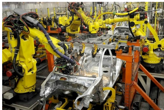
Figura 5 - Robôs de soldadura na indústria automóvel [48]
