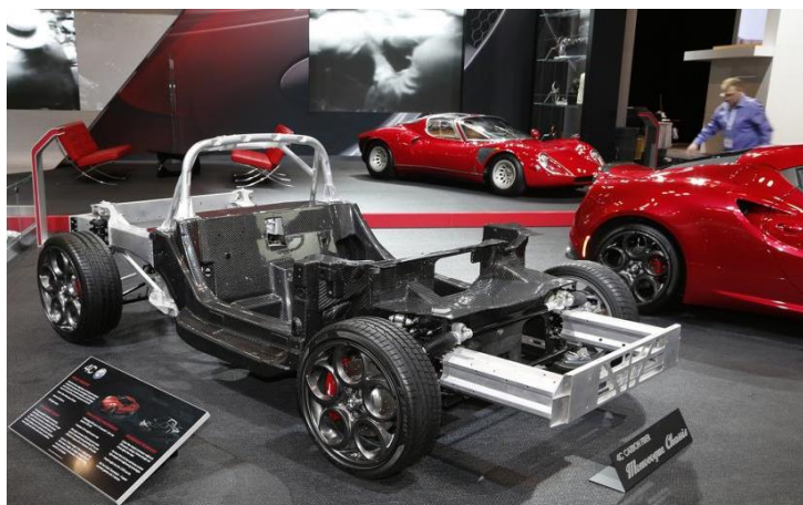
Figura 3 - Space frame do Alfa Romeo 4C [8]
