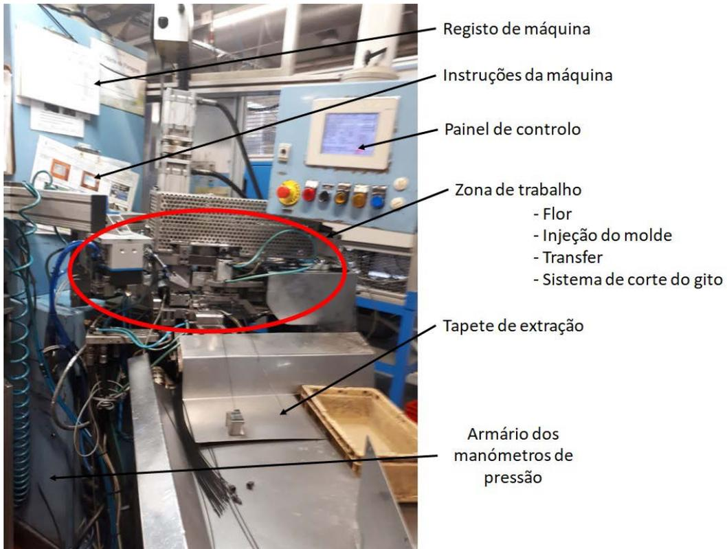
Figura 27 - Principais elementos de uma máquina semi-automática
