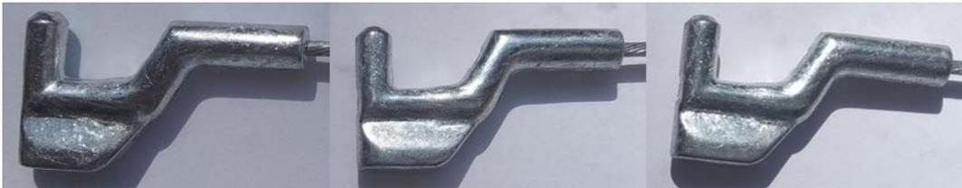
Figura 84 - Análise visual dos provetes do molde melhorado
