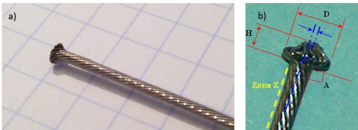
Figura 13 - a) Flor efetuada na extremidade de um cabo metálico; b) Dimensões principais da flor [21]
