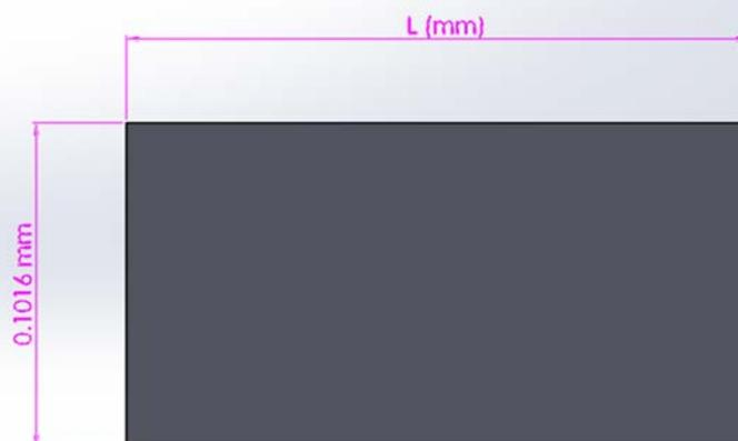
Figura 82 - Forma e dimensões dos escapes de gases aplicados aos moldes
