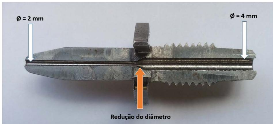
Figura 36 - Secções no interior de um bico de injeção
