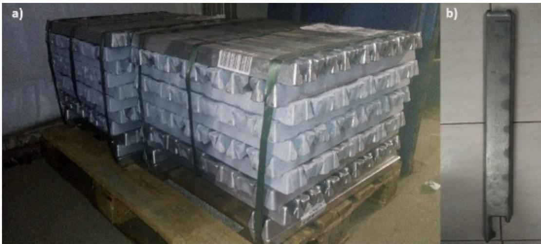
Figura 55 – a) Lote de lingotes de *Zamak* 5, b) Barra de *Zamak* 5
