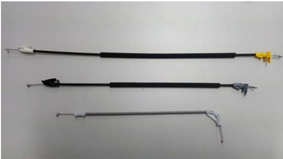
Figura 6 - Cabos de comando para acionamento de portas e vidros
