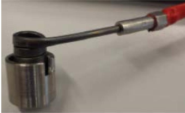
Figura 40 - Esquema de uma resistência no interior de um invólucro [16]
