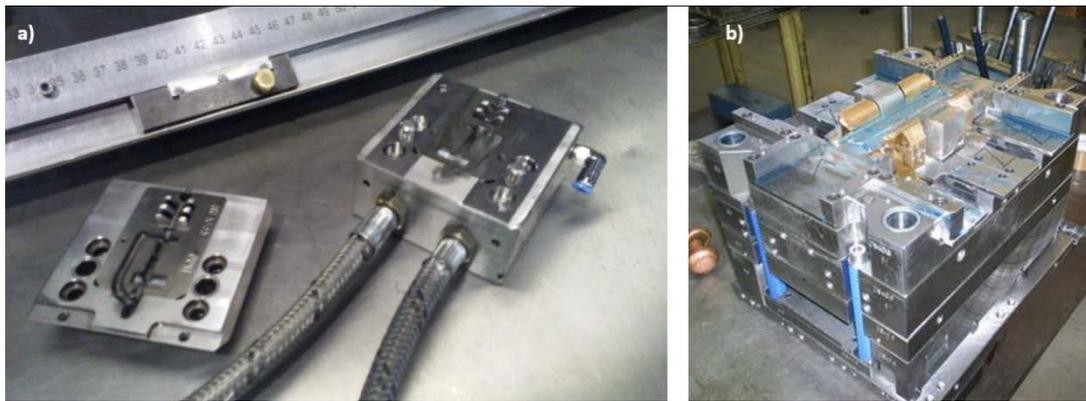
Figura 41 - Diversos tipos e tamanhos de moldes para injeção; a) Molde para injeção de pequenas peças, b) Molde de grandes dimensões para obtenção de peças grandes
