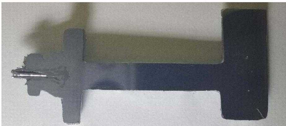
Figura 76 - Amostra com polimento efetuado e superfície brilhante
