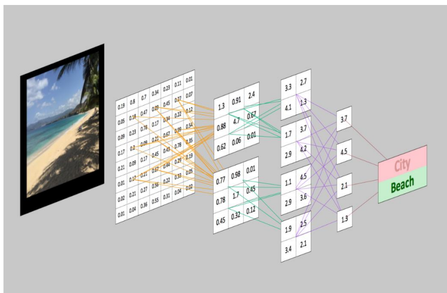
Figura 10 - Extração de Características numa CNN (Gibson et al., 2017)
