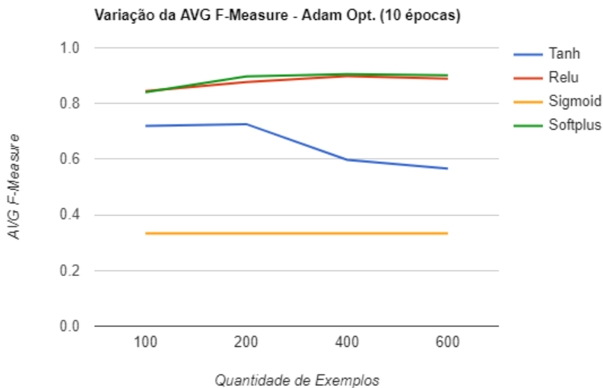
Figura 40 - Variação da média da F-Measure com aumento do dataset - 2ª Abordagem para classificação binária (exemplos de 30 segundos)
