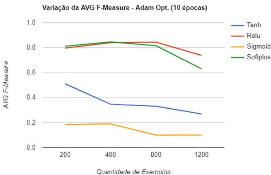
Figura 37 - Variação da média da F-Measure com aumento do dataset - 2ª Abordagem para classificação multiclasse
