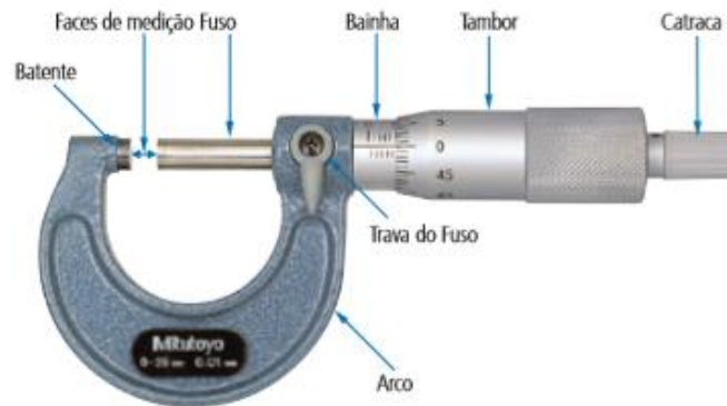
Figura 15 – Micrómetro [Reproduzido de: (36)]
