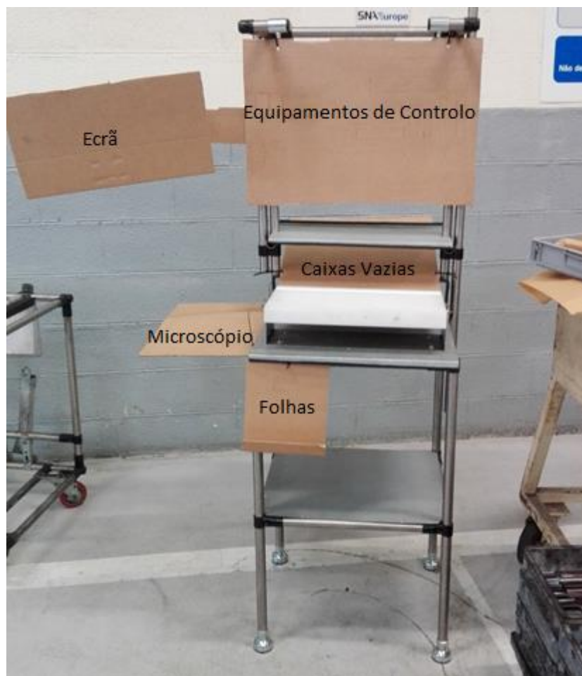
Figura 35 - Mesa de Trabalho da Inspeção Final
