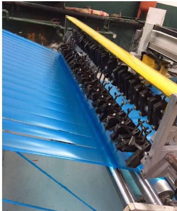
Figura 19 – Novo sistema de corte instalado numa extrusora
