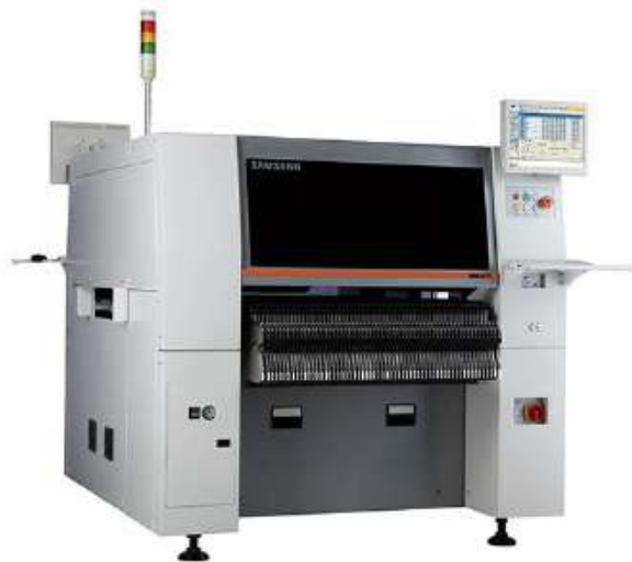
Figura 5 – Sistema Pick & Place para colocação de componentes elétricos (Pereira, 2016)
