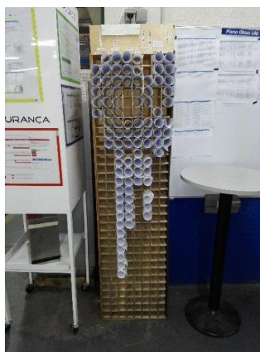
Figura 26 – Caixa de Nivelamento.
