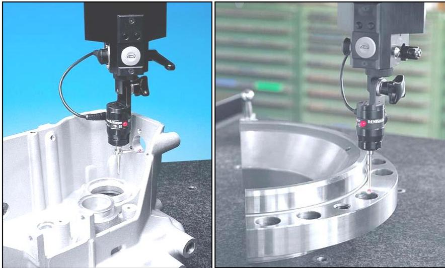
Рис. 7.45. Измерительные системы Renishaw, применяемые в базовой комплектации КИМ Etalon Derby 454
