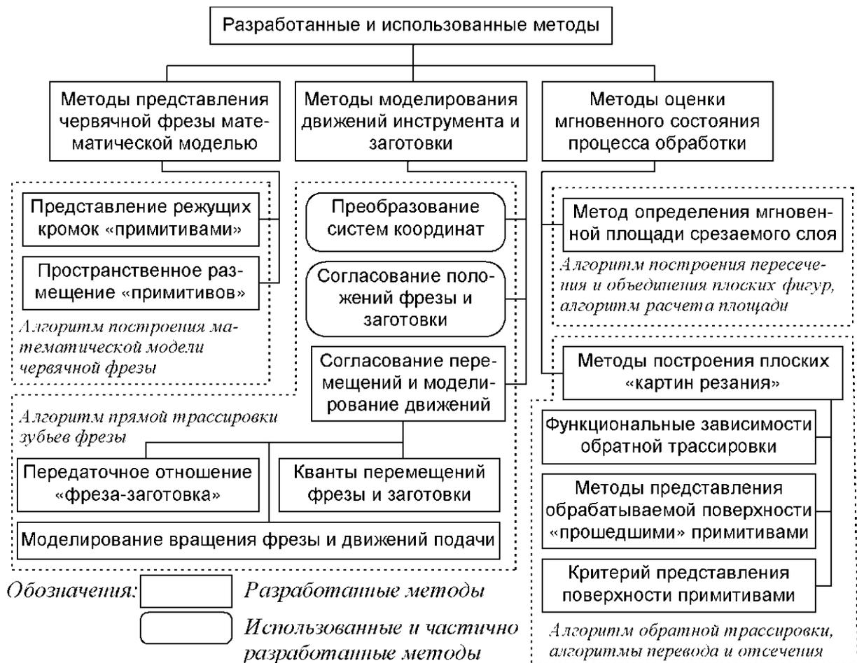
Рис. 6.8. Схема разработанных методов и алгоритмов моделирования обработки ЗК
