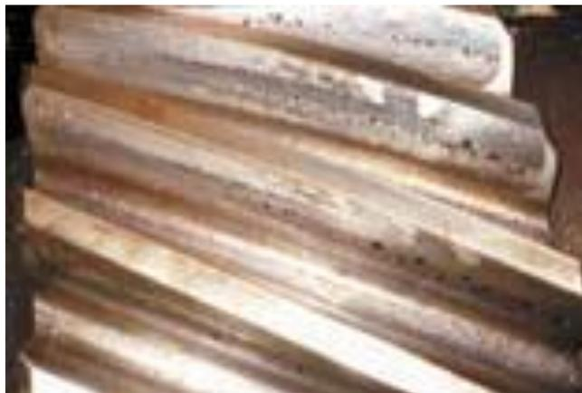
Рис. 6.25. Состояние активных поверхностей зубьев при наличии прогрессирующего выкрашивания
