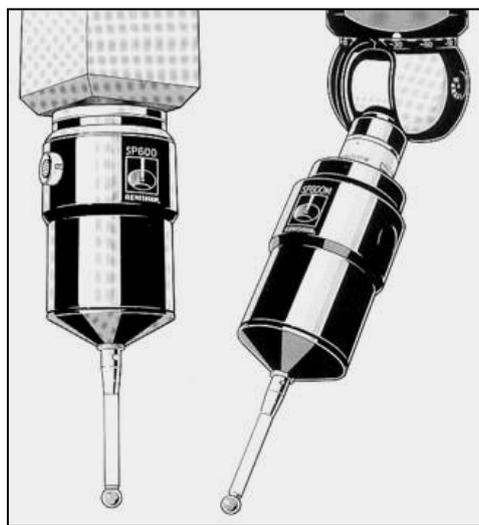
Самоцентрирующий механизм датчика обеспечивает возврат щупа в нулевую позицию с максимальной погрешностью, не превышающую 5 мкм.
