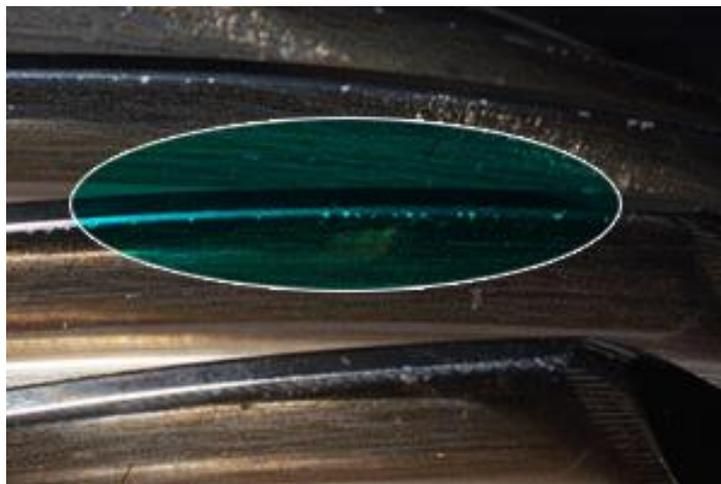
Рис. 6.38. Образование питтингов на поверхности зуба колеса
