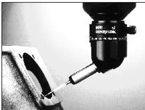
Рис. 7.73. Ручная головка МН8
