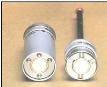
Рис. 7.59. Датчик TP200 с узлом установки щупа
