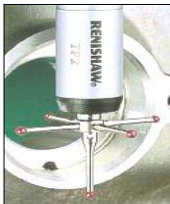
Рис. 7.66. Контактный датчик TP2 – 5W
