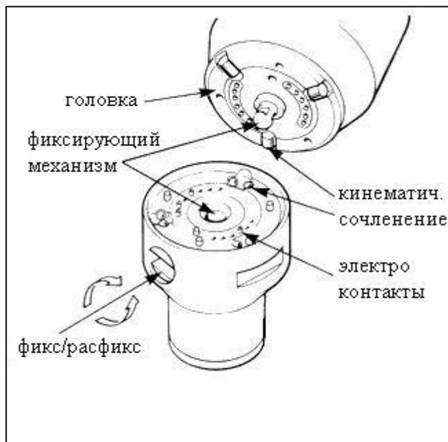
Рис. 7.71. Высокоточное кинематическое соединение
