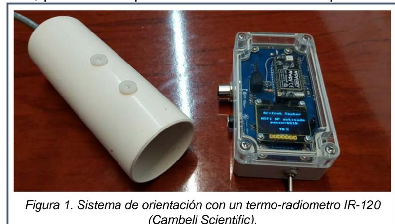
Figura 1. Sistema de orientación con un termo-radiómetro IR-120 (Campbell Scientific).
