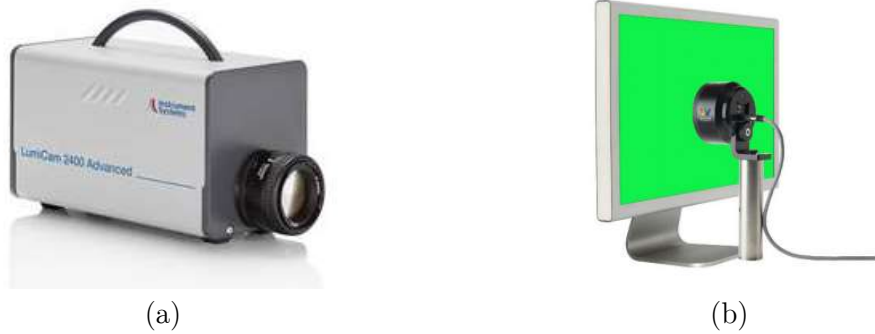
Figura 2.8 (a) Modelo de fotómetro LumiCam 2400 Advanced fabricado por Instruments Systems, permite adecuar el ángulo de visión, entre 5^\circ y 15^\circ , la aplicación específica para la que han sido desarrollados es la caracterización de la iluminancia de pantallas LCD. (b) Fotómetro modelo Conometer® 80 fabricado por Westboro Photonics, presenta un ángulo de visión de 80^\circ gracias a un sistema de lentes conoscópico con una resolución angular de 0.22^\circ .
