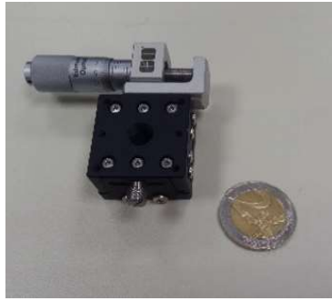
Figura 4.5 Fotografía del modelo de microposicionador utilizado, #66-401 (Edmund Optics™). Este modelo de microposicionador presenta un recorrido total de 13 mm con una precisión de 0.01 mm.
