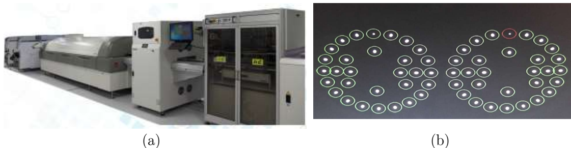
Figura 2.5 (a) Fully automated in-line test system for testing LED light engines desarrollado por ATE Solutions. Este sistema de validación in-línea de componentes fotónicos evalúa la ausencia o si el componente fotónico no emite suficiente flujo luminoso. (b) Aspecto del registro que evaluar el sistema de ATE Solutions, donde se indica mediante un círculo rojo que el componente fotónico no emite suficiente flujo luminoso.
