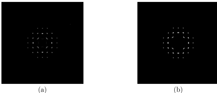
Figura 3.26 (a) Registro en que el componente fotónico tipo se encuentra 0.5 mm por encima de la posición de foco, más cerca de la malla. (b) Registro en que el componente fotónico tipo se encuentra 0.5 mm por debajo de la posición de foco, más alejado de la malla. Se observa claramente como los spots mantienen la misma estructura en ambos registros de modo que podemos descartar la presencia de cruces entre ellos.
