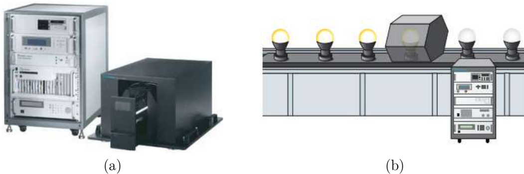
Figura 2.6 (a) Vista del test en línea de componentes fotónicos destinados a iluminación, modelo 58158-SC desarrollado por Chroma A.T.E. Este modelo ofrece medidas del flujo luminoso total emitido, y parámetros prioritarios en los componentes aplicados a la iluminación como la temperatura de color correlacionada y el índice de reproducción cromática. (b) Ilustración donde se indica el modelo 58158-SC operando línea.
