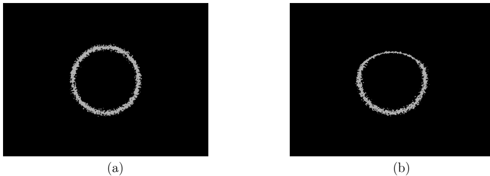
Figura 7.26 Regiones anulares resultado de aplicar el criterio de la ecuación (3.14) a los registros (a) nominal (b) con defecto. Los valores de excentricidad que presentan son: 0.23 y 0.40.
