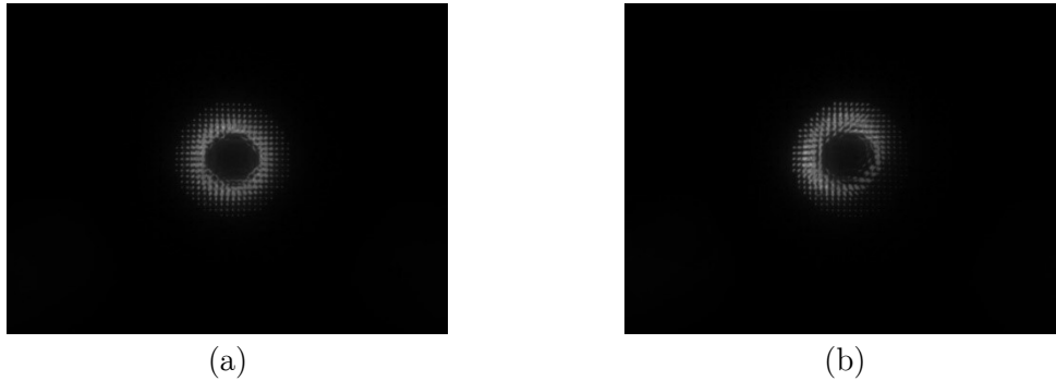
Figura 6.41 Registros de spots del control óptico de calidad ( \theta > 35^\circ ) (a) nominal y (b) componente situado en posición nominal pero con el LED descentrado. La dimensión de todos los registros es de 240 \times 175 \text{ mm}^2 ( 1294 \times 970 \text{ píxeles}^2 ), con 256 niveles de digitalización normalizados a un máximo común para los tres registros experimentales, cuyo valor es 185.
