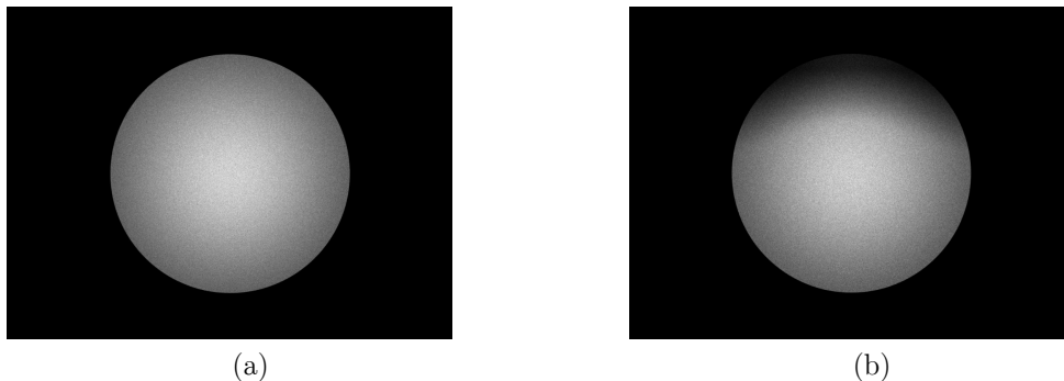
Figura 7.25 Registro simulado correspondiente al caso nominal (a), y al caso con defecto, (b). La dimensión de todos los registros es de 240 \times 175 \text{ mm}^2 ( 1294 \times 970 píxeles 2 ), con 256 niveles de digitalización normalizados 255. Los de flujos radiantes totales en unidades arbitrarias son 0.3148 y 0.2679, respectivamente.
