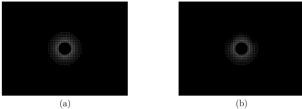
Figura 7.31 Registros de spots del control óptico de calidad ( \theta > 35^\circ ). (a) Caso nominal, (b) caso con defecto. La dimensión de todos los registros es de 240 \times 175 \text{ mm}^2 ( 1294 \times 970 \text{ píxeles}^2 ), con 256 niveles de digitalización normalizados a 255.
