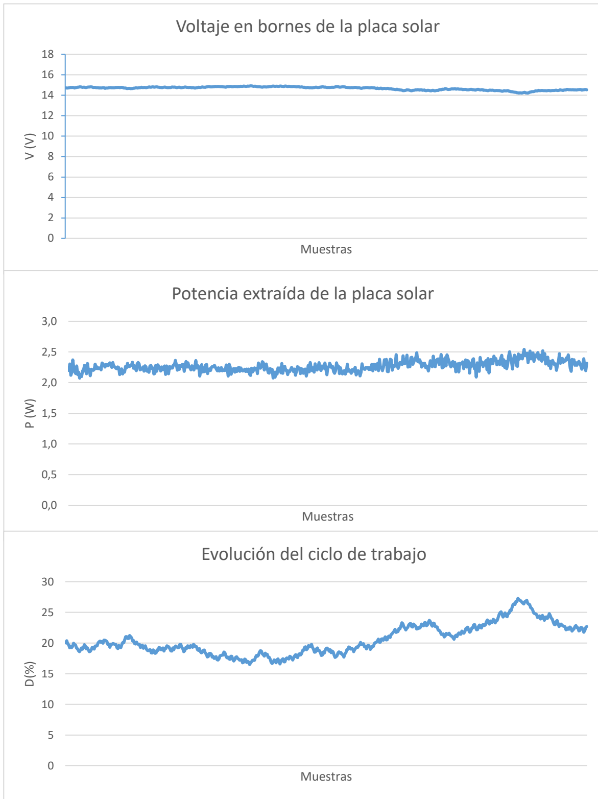
Fig 73 Resultados obtenidos mediante simulación aplicando el algoritmo INC
