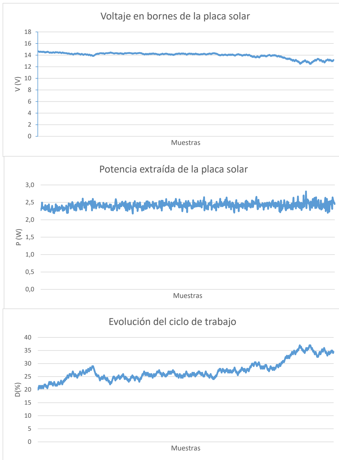
Fig 65 Resultados experimentales obtenidos aplicando el algoritmo P&O
