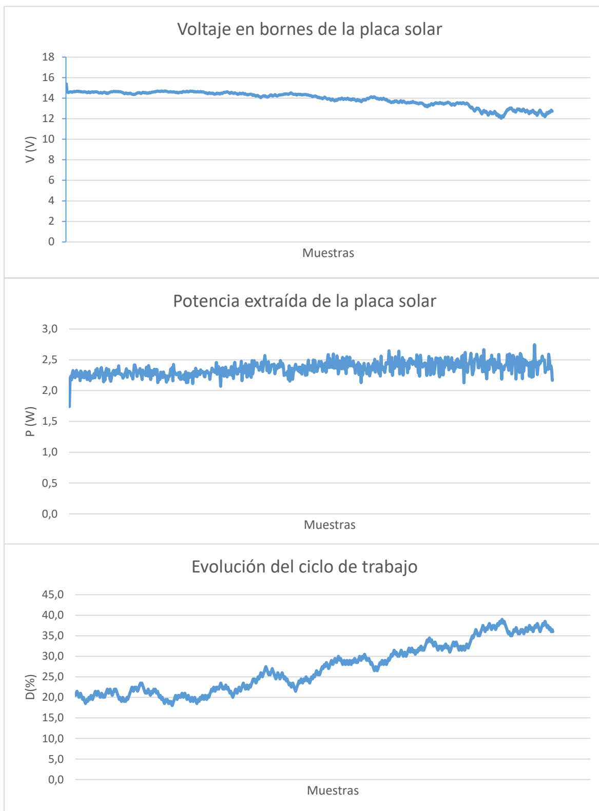
Fig 58 Resultados experimentales obtenidos aplicando el algoritmo Hill Climbing
