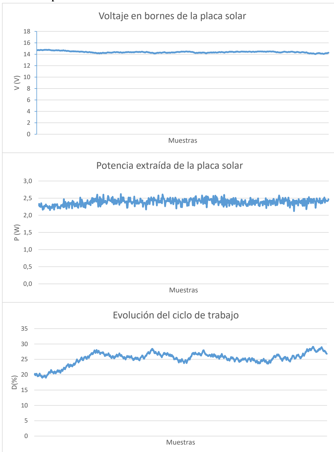
Fig 74 Resultados experimentales obtenidos aplicando el algoritmo INC con N=0.02
