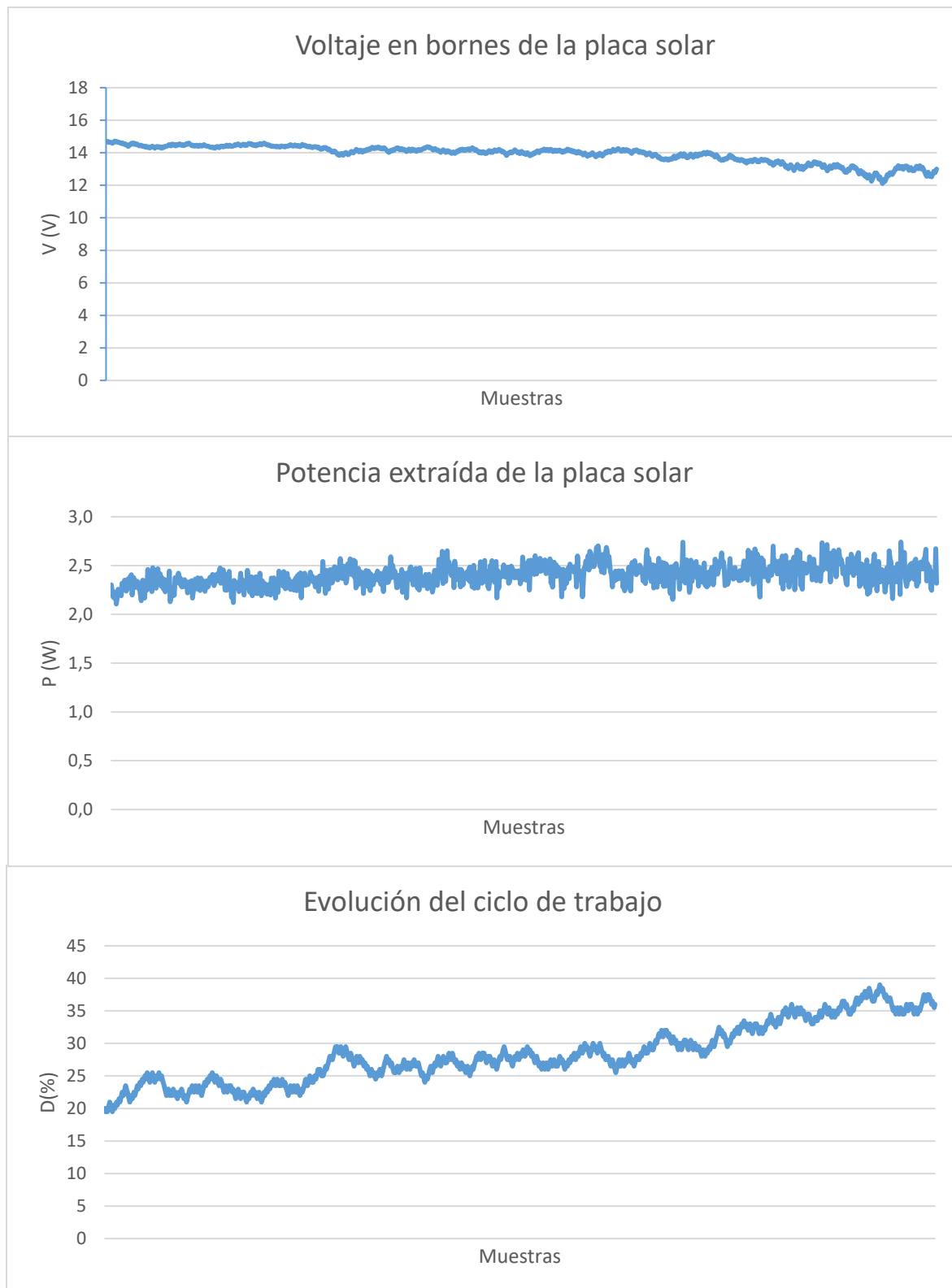
Fig 71 Resultados experimentales obtenidos aplicando el algoritmo IC
