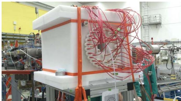
**Figura 1.** *Detector BELEN durante la calibración en el PTB (“The National Metrology Institute of Germany”). Se puede observar la matriz de polietileno y el cableado de los detectores de neutrones*
