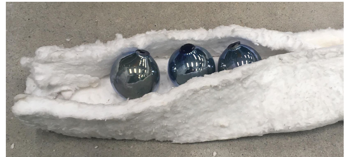
Fig. 30. Annealing in thermal blanket
