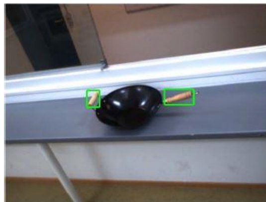
Figura 19: Imagen donde el robot reconoce los objetivos para conocer los puntos de agarre para ambas manos. Fuente: Vahrenkamp, Nikolaus; Böge, Christian; Welke, Kai; Asfour, Tamim; Walter, Jürgen; Dillman, Rüdiger, Visual Servoing for Dual Arm Motions on a Humanoid Robot, 9th IEEE-RAS International Conference on Humanoid Robots, Humanoids09 (2009).
