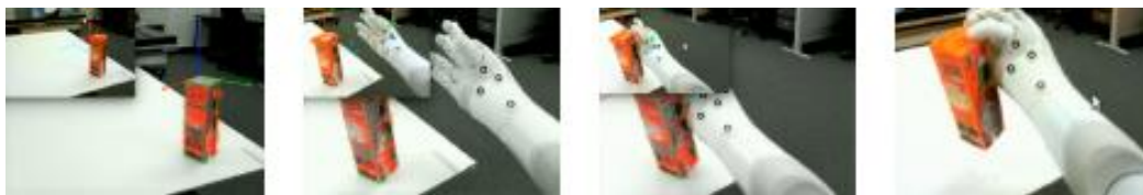
Figura 21: Proceso de agarre de un objeto cualquiera del método destacado. Fuente: Ardón, Paola; Dragone, Mauro; Erden, Mustafa, Reaching and Grasping of Objects by Humanoid Robots Through Visual Servoing, Lecture Notes in Computer Science, vol 10894 (2018)
