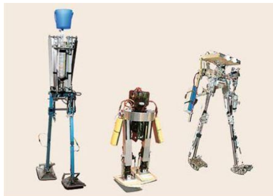
Figura 4: Ilustración de algunos tipos de robots con locomoción bípeda pasiva. Fuente: Siciliano, Bruno; Oussama, Khatib. Springer Handbook of Robotics. Nápoles, Italia. Springer, vol 1, 2008. p 1312-1315.
