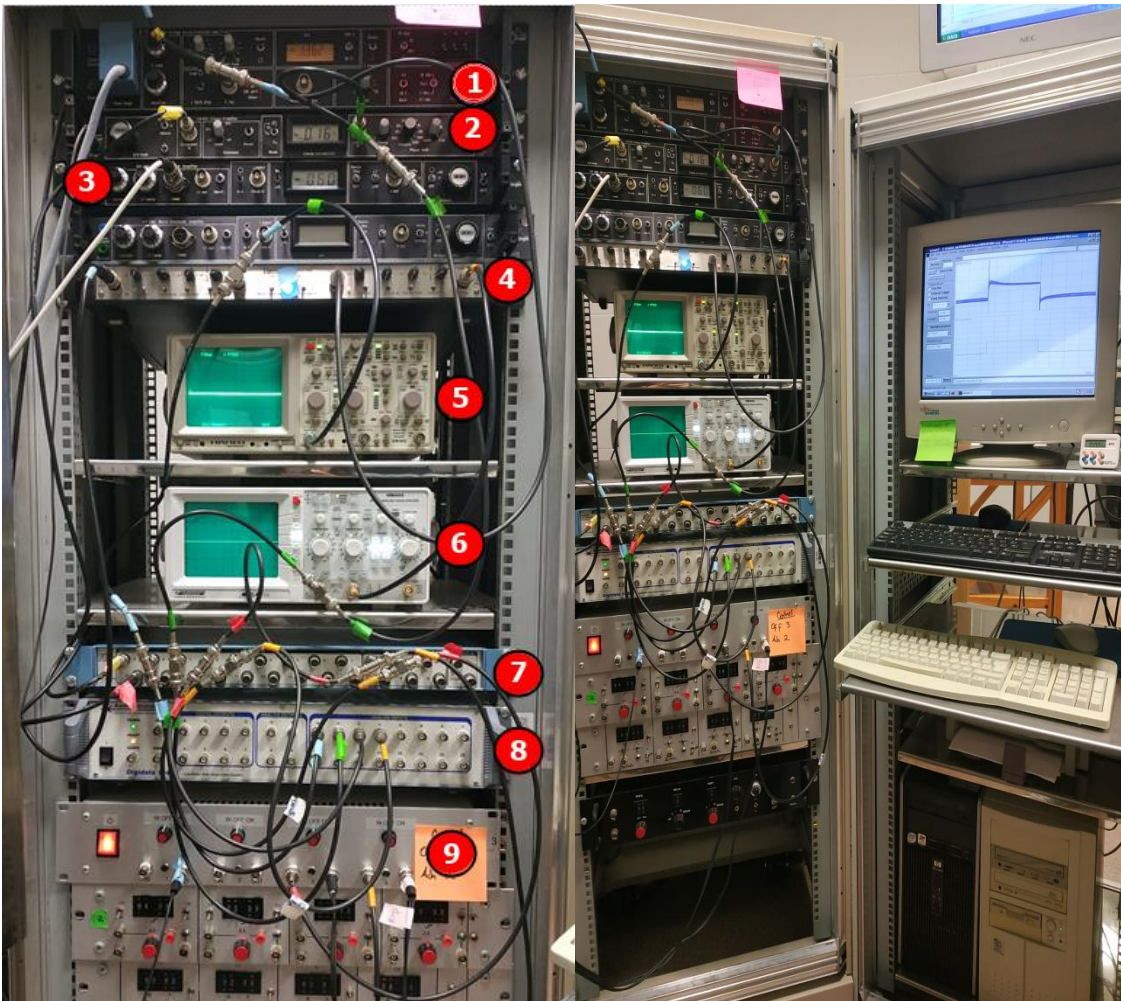
Figura 8. Equipo para el registro de corriente en ovcitos. Vista general (derecha) de los racks donde se encuentran los ordenadores y equipo necesario para el registro. Vista en detalle (izquierda) del amplificador de corriente (1), amplificador diferencial (2), amplificador de voltaje (3), unidad de filtros (4), osciloscopios (5 y 6), convertidores A/D (7 y 8) y controlador de válvulas (9).
