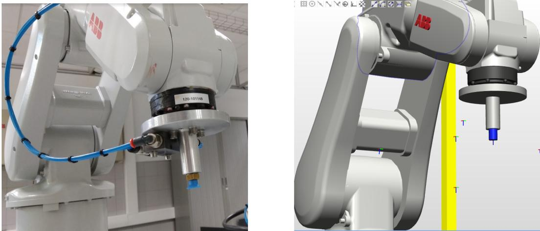
Figure 5.1: Ensamblaje de la herramienta en el robot real y en el simulado
