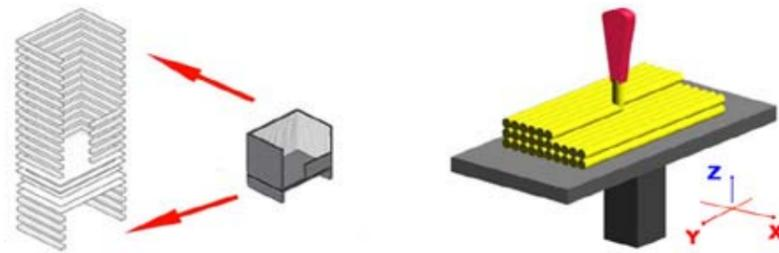
Figura 2: Descomposición en multicapas de una pieza y construcción aditiva.
