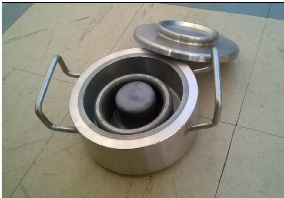
Slika 3.2. Vibro posuda korišćena za mlevenje, oznake Fritch Pulverisette Analysette Laborette [119].
