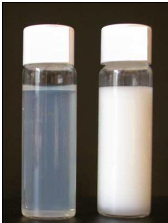
Slika 2.10. Izgled nan-emulzije (levo) i mikro emulzije (desno) veličine čestica u proseku iznose 35 nm i 1 \mu m [97]
