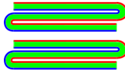
Abb. 2.10: Piezoelektretstapel bestehend aus s = 2 gefalteten Elementen mit jeweils p = 3 Schichten. Insgesamt besteht der Stapel aus n = sp = 6 Schichten.
