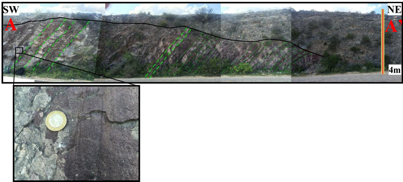
Figura 3. 6: Muestra fotoperfil I de la Formación La Boca en corte de la carretera que conecta el municipio de Aramberri N.L con el poblado El Mezquital, donde se muestran los paquetes de areniscas con coloraciones moradas que en parte presenta intercalaciones de lutitas con una cubierta o ‘costra’ de material calcáreo de tonos blancos, se muestra también espesores de las capas que va de gruesos a delgados de izquierda a derecha. Asimismo, se puede apreciar en un zoom, el ordenamiento tamaño y arreglo de los granos y la costra del material calcáreo (Letras A-A’ correspondiente al perfil estratigráfico A del Anexo I, las líneas punteadas verdes representan el acomodo de las capas, la línea de color rojo la escala y la línea de color negro representa el límite entre la Formación y material cuaternario indiferenciado; coordenads UTM: 2672468m N – 14-0421758m E).
