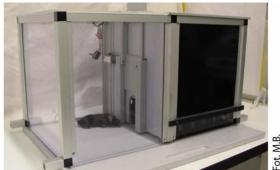
Abb. 35 Fotoaufnahme der *Light Dark Preference*-Versuchsbox
