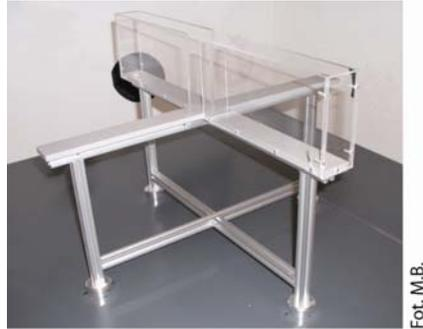
Abb. 34 Darstellung des *Elevated Plus Maze*-Apparates
