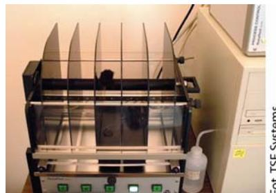
**Abb. 33 Aufnahme des *Rotarod*-Apparates**
