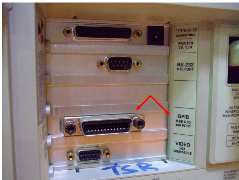
Abbildung 6.4: Das TDS 380 verfügt über eine GPIB-Schnittstelle, über die es mit einem PC gesteuert werden kann.
