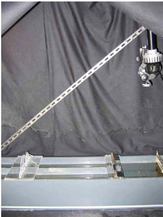
Abb. 8: Strömungskanal. Fließrichtung des Wassers von links nach rechts. Videokamera oberhalb des Testbereichs nimmt das Verhalten des Weibchens auf.
