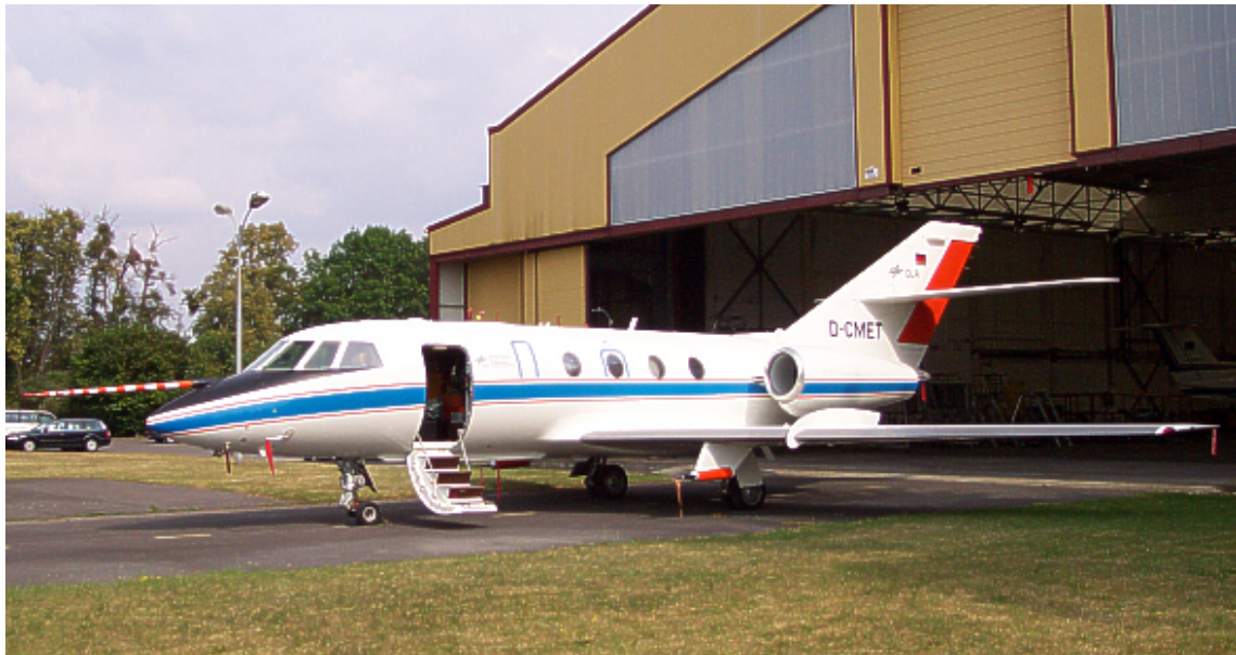
Abbildung 5.1: Das Flugzeug des DLR, die Falcon. An der Oberseite des Flugzeuges gut zu erkennen die verschiedenen Einlassstutzen. An den Flügeln angebracht die Partikelzähler.
