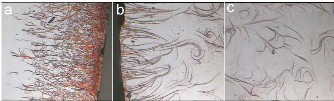
Abbildung 3.21: Mikroskopische Aufnahmen einer durch drop-casting prozessierten Lösung von BPF-PDI auf \text{SiO}_x , (a-c) 520-471 \mu\text{m} .
