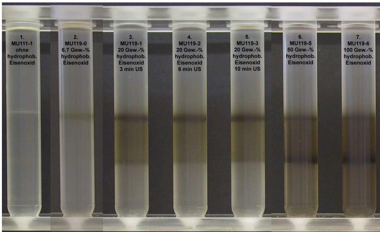
**Abb. 25:** Präparative Ultrazentrifugation im Zucker Dichtegradienten von PLLA-Partikeln mit verkapselten hydrophobisierten Eisenoxidnanopartikeln: Gew.-% Angaben geben die eingesetzten Mengen an hydrophobisierten Eisenoxidpartikeln im Verhältnis zu PLLA an.
